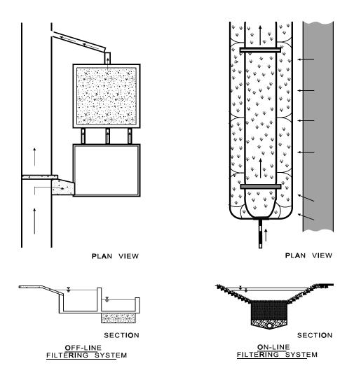
SCHEMATIC: ON-LINE vs OFF-LINE
