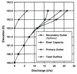
Figure 3.4.2-10 Composite Stage-Discharge Curve
