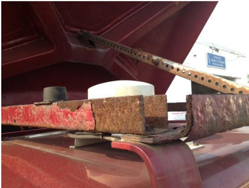
FIGURE 6.12. CORRODED AIR SHIELD SUPPORT FRAME (PHOTO FROM [126])
