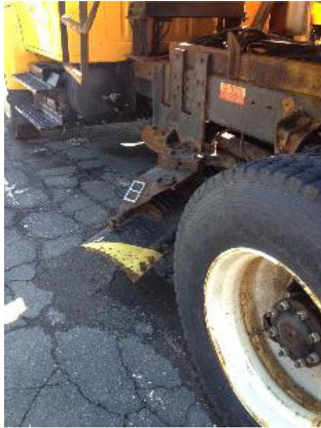
FIGURE 7.1. UNDERBODY SCRAPER BLADE IN THE UP POSITION
